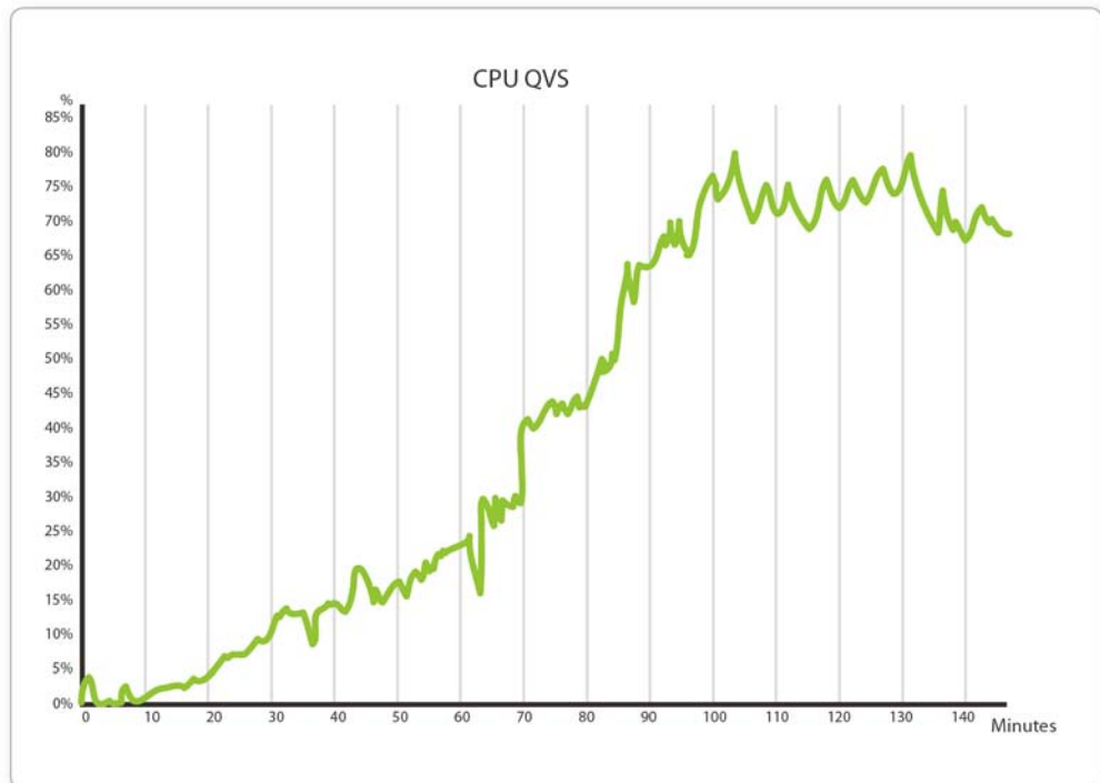
図 20 : パフォーマンスで測定したテスト セッション中の CPU ロード
